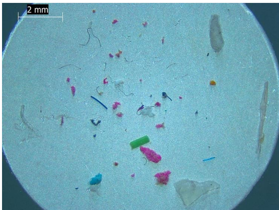
figura 39: filtro con microplastica dalle acque superficiali filtrate del Ticino per l'analisi della composizione chimica.
