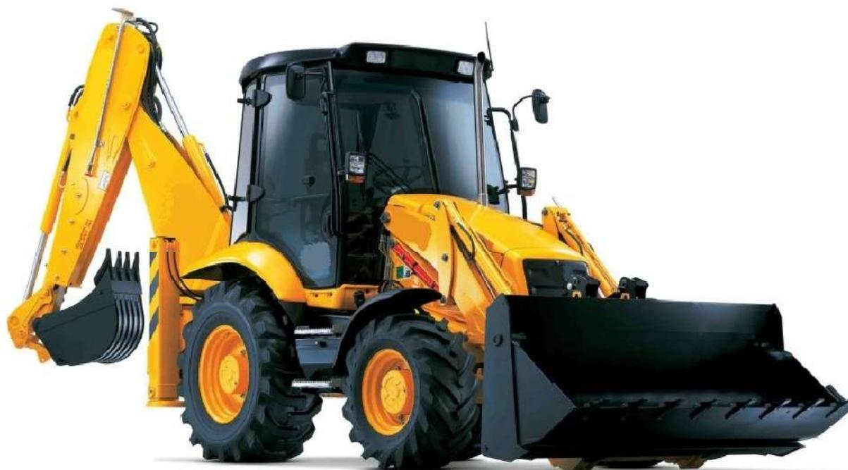
Le Terne rappresentano un segmento particolare delle macchine movimento terra. Nascono in origine all'applicazione su trattori agricoli di una benna di caricamento nella parte anteriore e di un braccio dotato di un piccolo cucchiaio, montato posteriormente. Sono macchine molto versatili e vengono utilizzate in lavori di piccola entità, in spazi circoscritti, per l'esecuzione di canalizzazioni, pulizia canali, fosse, scavi non molto profondi, sistemazioni forestali e agricole, etc.
