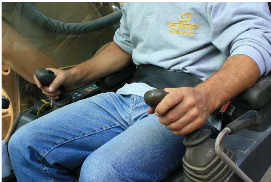
Operatore alla guida dell'escavatore vincolato al sedile con regolare cintura di sicurezza
