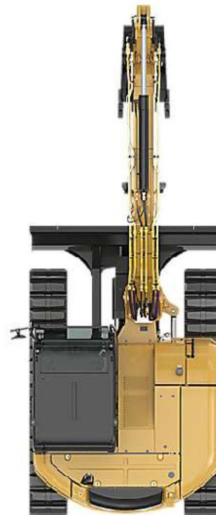
Il Mini-escavatore idraulico cingolato (ferro o gomma) consente d' eseguire lavorazioni in spazi ristretti o a filo delle strutture infatti la torretta ruota all' interno della sagoma della macchina .
