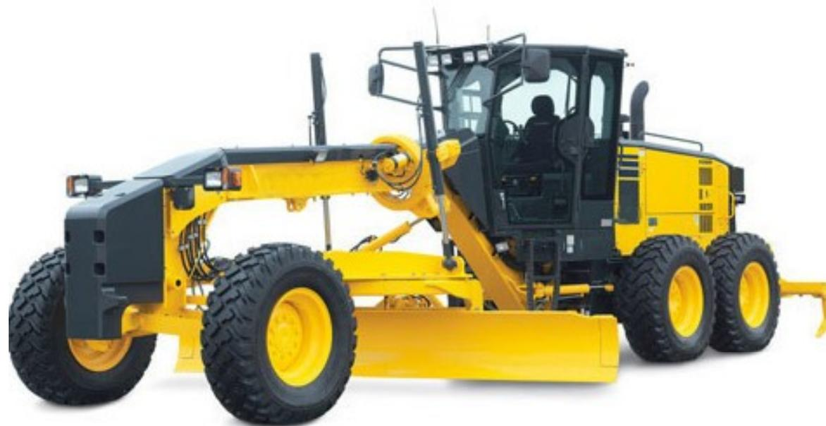
È un livellatore di materiale di finitura molto preciso e veloce. Viene usato per stendere il materiale "bianco" nella costruzione delle strade, cioè l'ultimo strato di ghiaia prima della asfaltatura. Viene usato anche per lavori di livellamento, taglio canali, profilature di scarpate.
