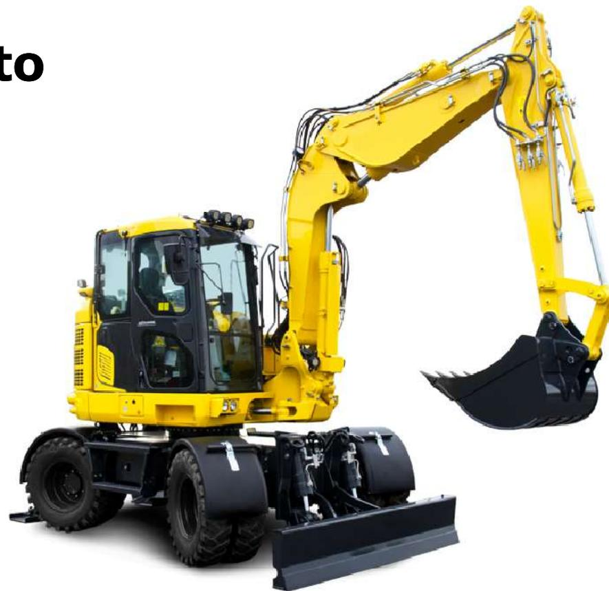
L'escavatore idraulico è la macchina movimento terra più versatile e importante oggi in commercio, con una quota di impiego di oltre il 50% rispetto alle altre macchine. L'escavatore idraulico può essere cingolato o gommato. In questo ultimo caso, se abilitato può circolare sulle strade pubbliche.
