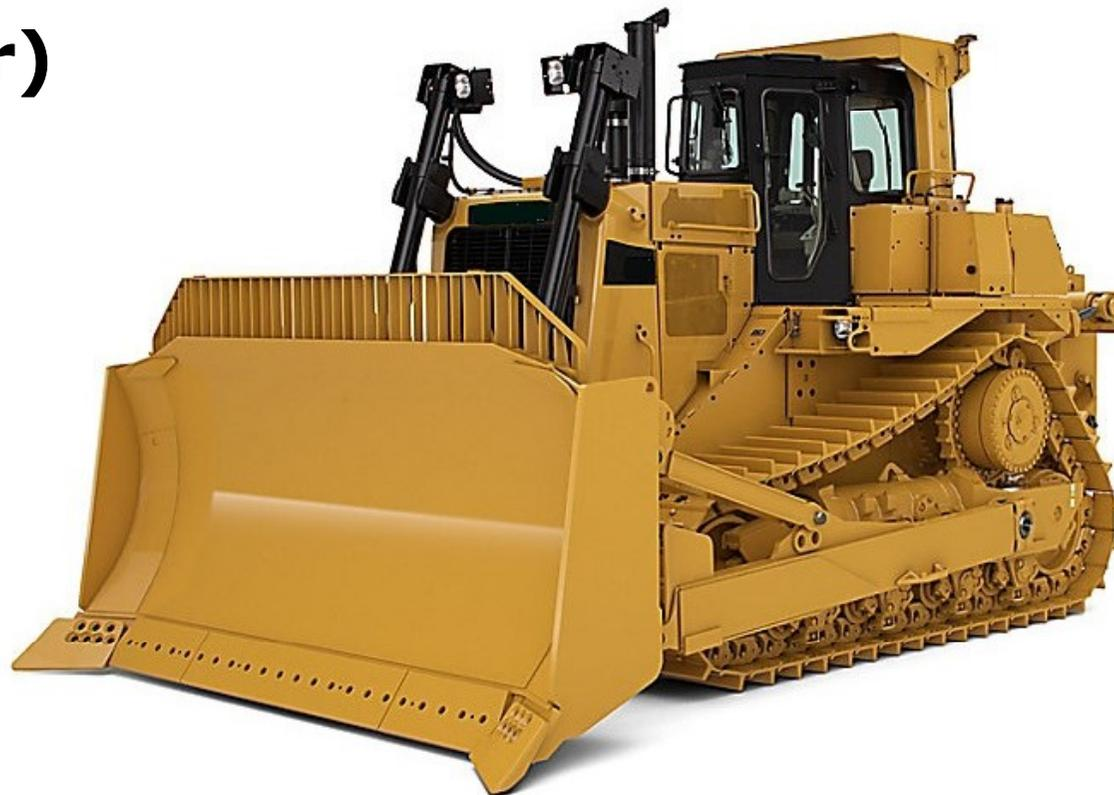
Sono macchine cingolate dotate nella parte anteriore di una grande lama (dozer), la quale affondata nel terreno da due pistoni idraulici, con il moto del mezzo spinge, sposta, livella il materiale di risulta.
