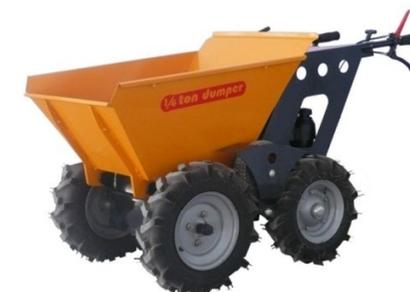
Essi vengono utilizzati nell'ambito di un cantiere sia edile che stradale e sono adibiti esclusivamente al trasporto di materiale. Possono spostarsi sui terreni accidentati e non pavimentati e sono dotati di cassone ribaltabile.
