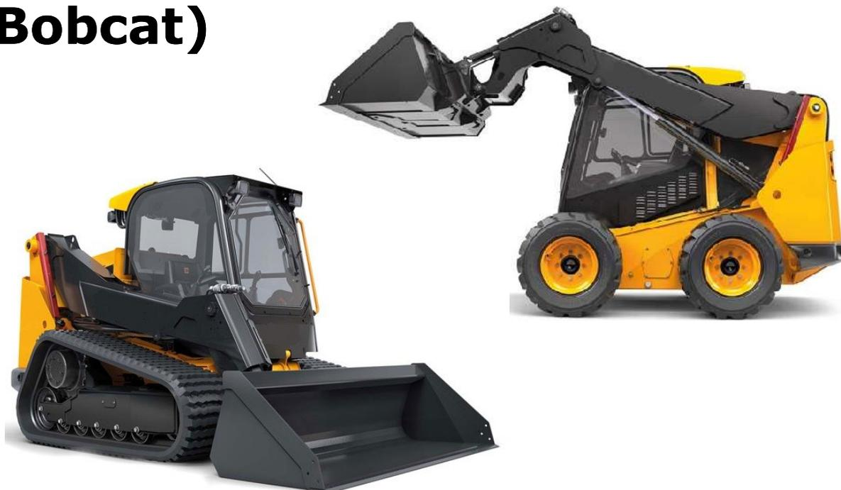
Sono macchine di piccole dimensioni e di ridotte capacità di scavo. Sono però molto efficienti e di facile uso e costruite per lavorare in spazi ristretti .
