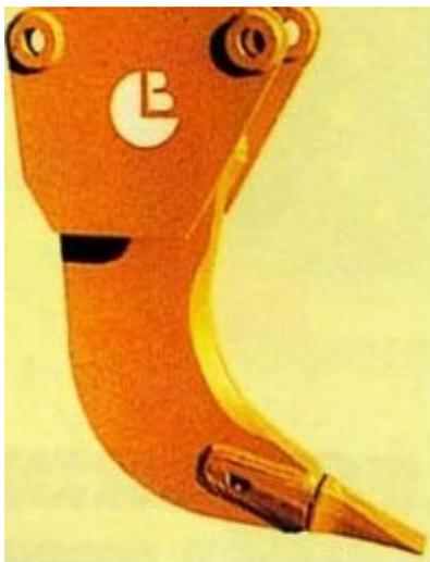
**Dente ripper** : attrezzatura per scarificare terreni molto duri o roccia. Sono disponibili diversi modelli, a seconda del tipo di escavatore e delle esigenze del cliente
