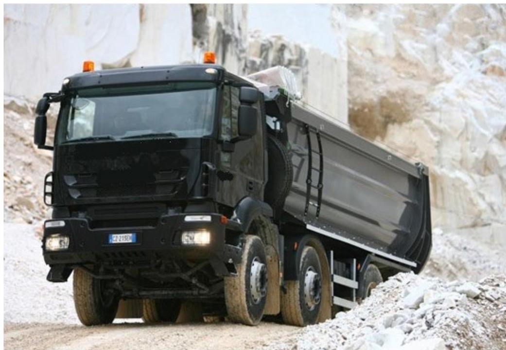
Gli autocarri sono utilizzati per il trasporto di terra, ghiaia, sabbia, in quanto sono omologati per circolare sulle strade pubbliche. Sono dotati di cassone ribaltabile anche di grandi dimensioni (mc 20).
