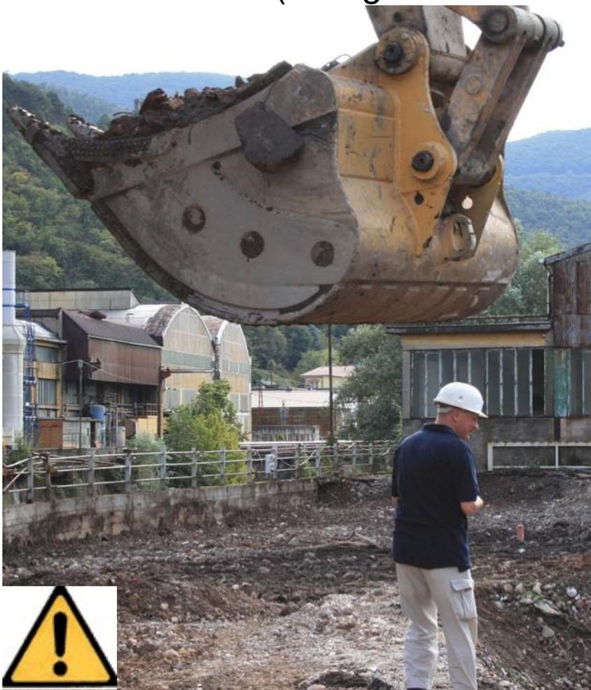
L'operatore controlla che non vi siano persone nel raggio d'azione della macchina
