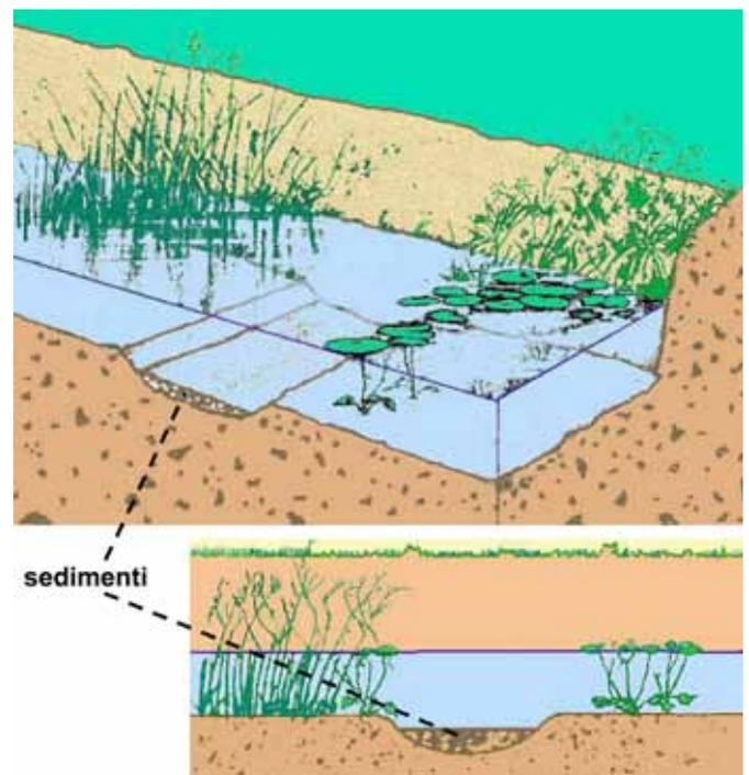
FIG. 6-45 REALIZZAZIONE ESEMPLIFICATIVA. SEZIONE DI UN INTERVENTO DI UNA TRAPPOLA PER FANGO. FONTE: NEWBOLD ET AL. 1989
