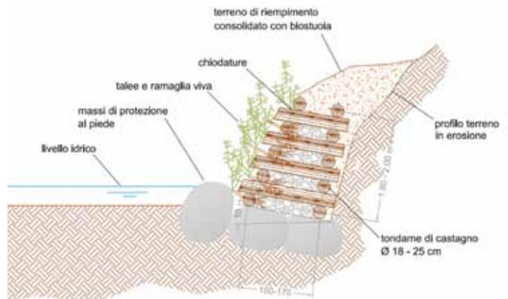
FIG. 6-10 SEZIONE DI UN INTERVENTO TIPO.
