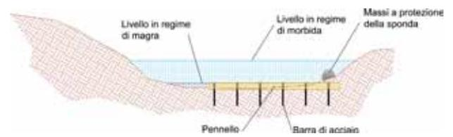
FIG. 6-25 SEZIONE DI UN INTERVENTO
