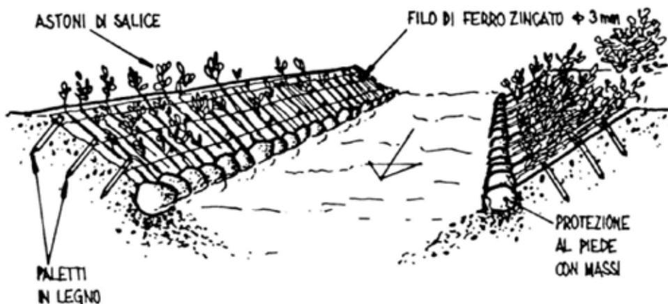
FIG. 6-9 SCHEMA DI POSA DELLA COPERTURA CON ASTONI (FONTE: DGR N. 6-48740, APPROVAZIONE DIRETTIVA "QUADERNO OPERE TIPO DI INGEGNERIA NATURALISTICA").
