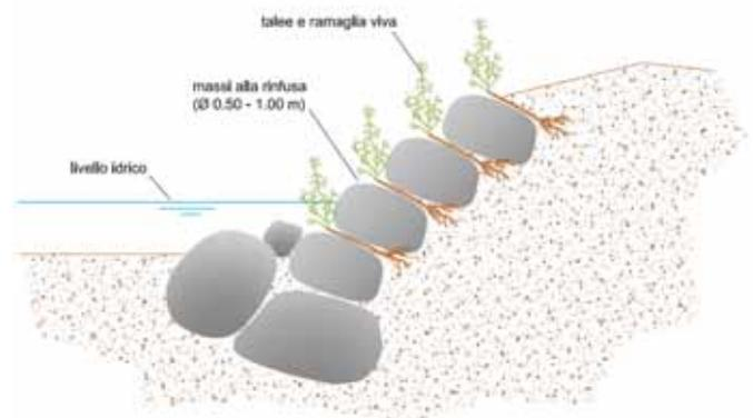
FIG. 6-12 SEZIONE DI UN INTERVENTO TIPO.
