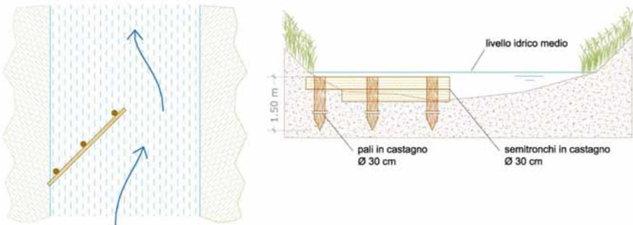
FIG. 6-30 DEFLETTORE SINGOLO - INTERVENTO TIPO. PLANIMETRIA E SEZIONI
