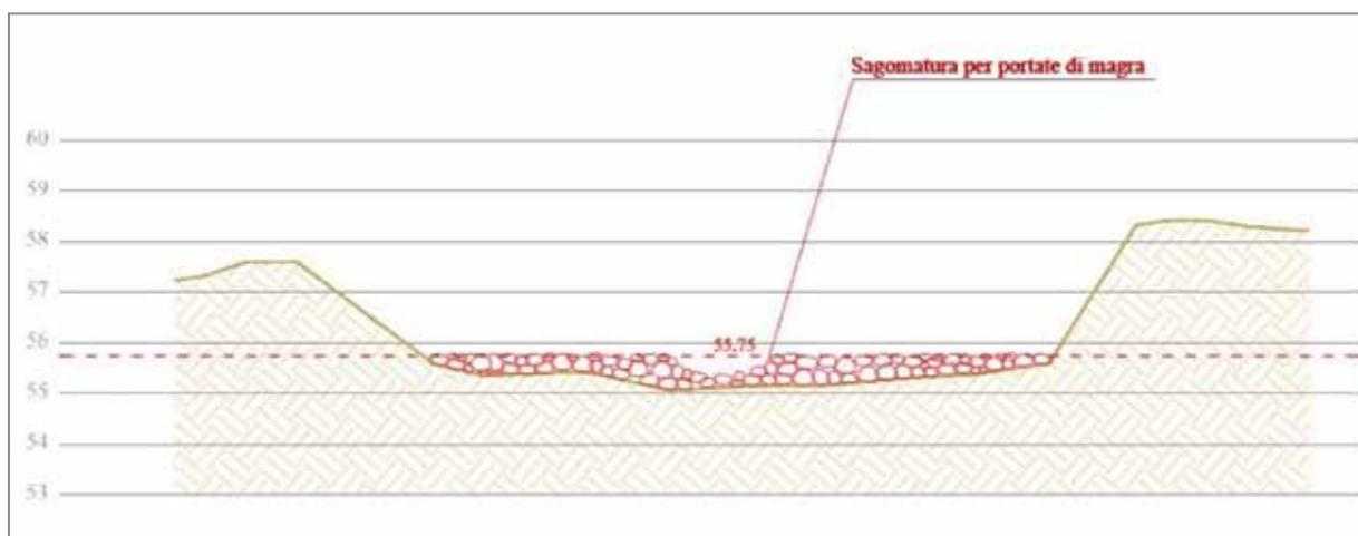
FIG. 8-2: SEZIONE DELL'INTERVENTO A VALLE DELLA CHIAVICA
