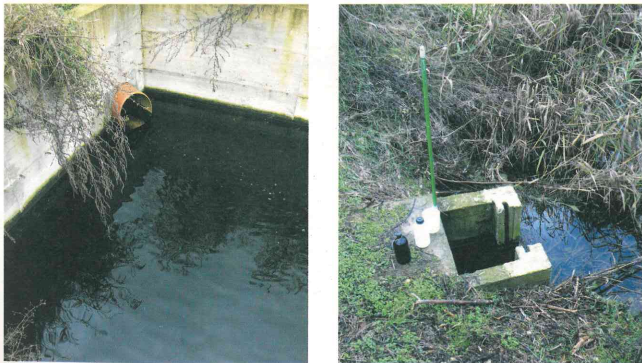
Fig. 4.14. - Punto di campionamento in ingresso (Cas1) e in uscita (Cas2) della fase di fitodepurazione.
