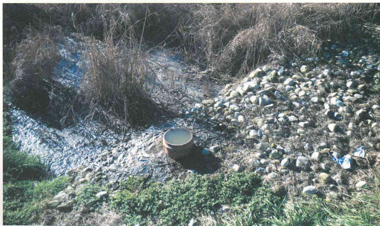
Fig. 4.6. - Formazione di flusso superficiale a seguito dello stallo del sistema
