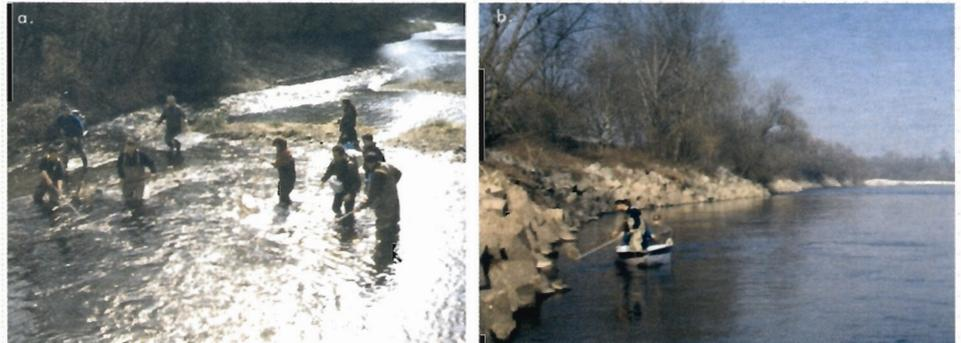
I campionamenti di fauna ittica mediante pesca elettrica sono stati effettuati con un elettrostorditore spallabile da 2 kW di potenza, modello Fichtel & Sachs ELT61/IIGI, con motore a scoppio, alimentato con corrente continua.
