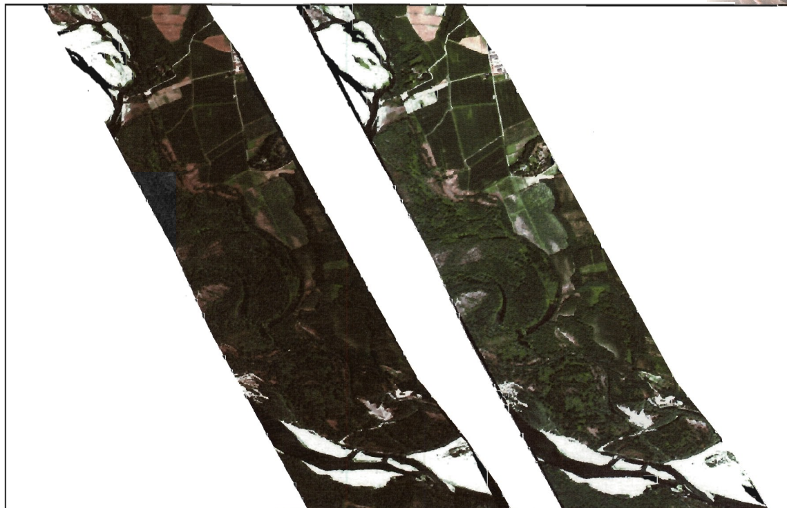
● Figura 63 Esempio di una scena ripresa da angolazioni diverse (strisciata 3 a sinistra, strisciata 4 a destra): si osservano evidenti variazioni legate alla geometria di ripresa
