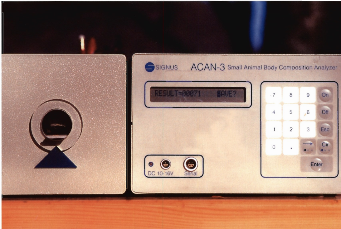
Strumento di rilevamento della conduttività elettrica corporea-tobec (foto di P. Bonazzi)
