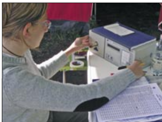
Nel corso delle operazioni di cattura e inanellamento è stato utilizzato uno strumento di tipo TOBEC per ottenere un indice della massa magra dei migratori catturati (Foto di P. Bonazzi).
