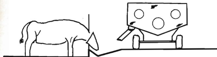
Figura 2 - Una corsia di alimentazione più stretta consente di ridurre i volumi della stalla.
